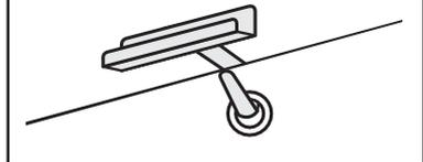
上図のようにサッシ取付金具を差し込み、締め付ビスでしっかりと固定してください。
